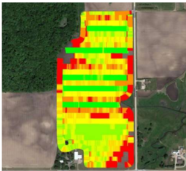
Рис. 1. Принципиальная карта дифференцированного внесения удобрений с использованием информационных технологий и алгоритмов ИИ
